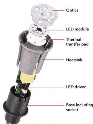
Rys. 18 Budowa podstawowego oświetlenia LED
